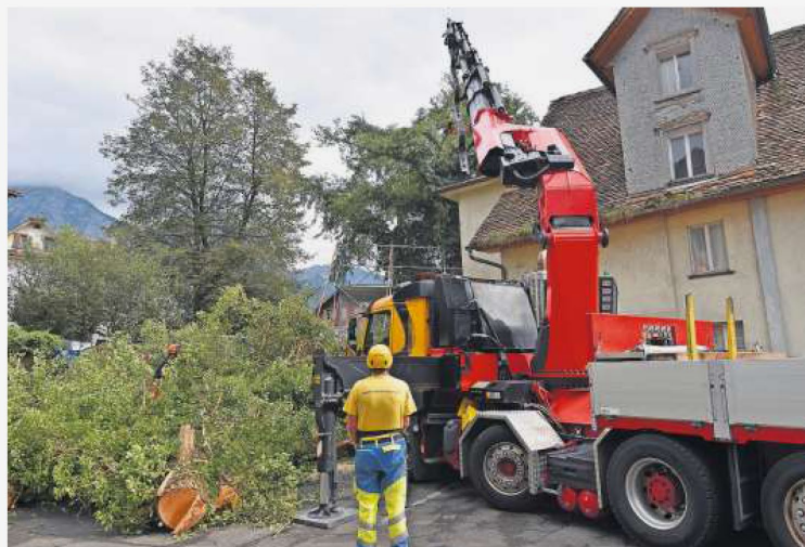
Der Baum wurde von oben her zersägt, die Äste wurden mit einem Kran auf einen Parkplatz gelegt.
